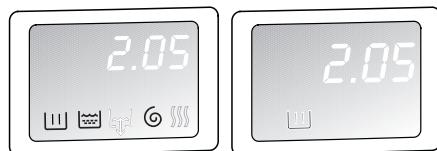
После нажатия кнопки “Старт/Пауза” и пуска машины будет гореть только значок, соответствующий выполняемой фазе программы. По окончании программы на дисплее высвечиваются 3 мигающих нуля “0.00”.
